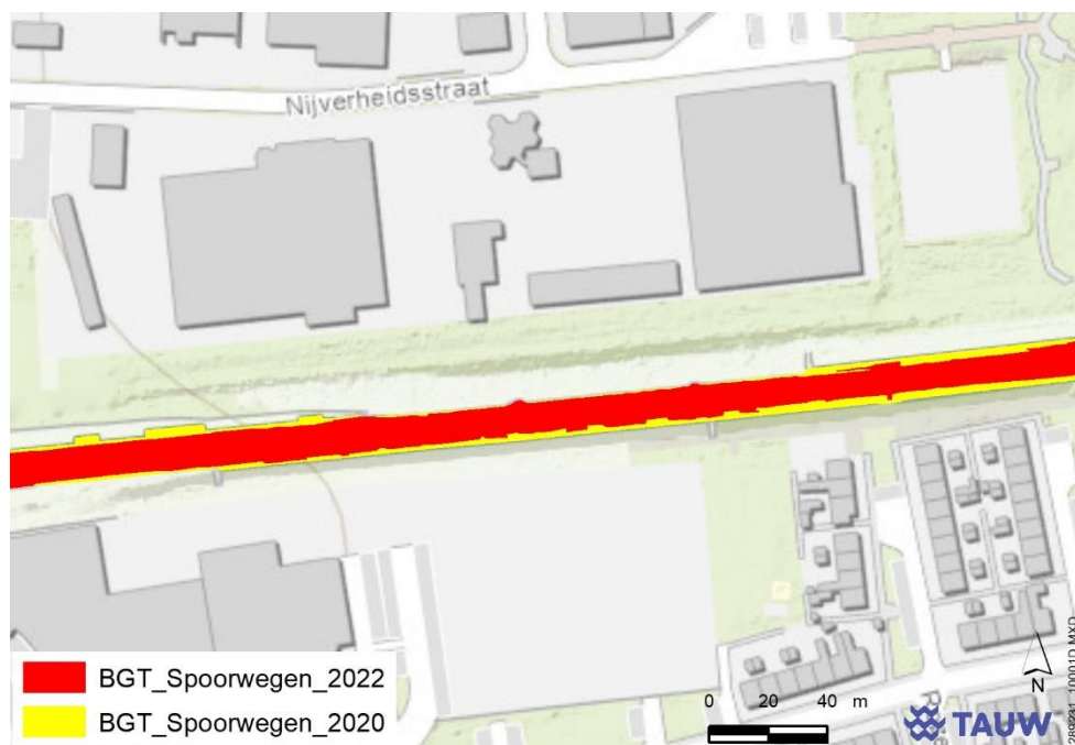
Figuur 3.1 BGT spoorwegen vergelijking voorbeeld nauwkeurigere inmeting Wierden
